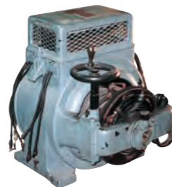
4P 3HP 当社初の三相直巻整流子電動機 (1927年 小倉工業学校納入)
