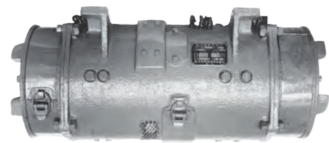
TDK301-A形電動発電機 (1926年 京成電気軌道納入)
