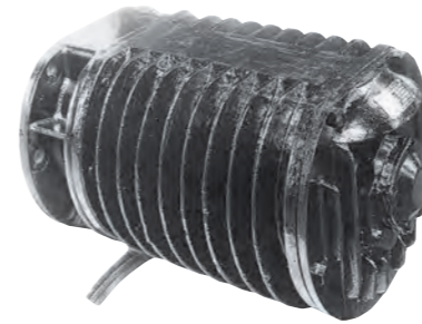
24P 6kg-m 赤熱銅塊運搬用ローラモータ (1938年～1939年 日本鋼管納入)
