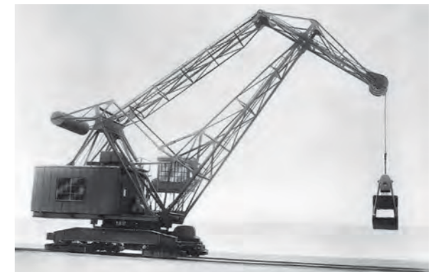
水平引込形起重機（1952年 小野田セメント納入）
