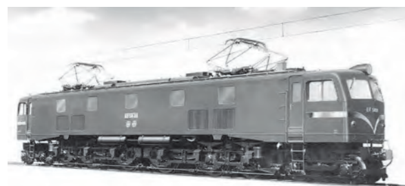
EF58形 115トン電気機関車 (1952年 国鉄納入)
