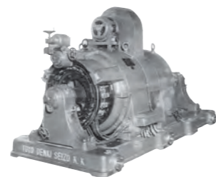
6P 200HP ST形三相分巻整流子電動機 (1950年 本州製紙江戸川工場納入)
