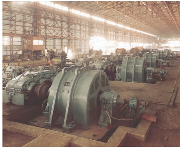
中型形鋼連続圧延設備用電気品 (1961年 東京製鐵納入)
