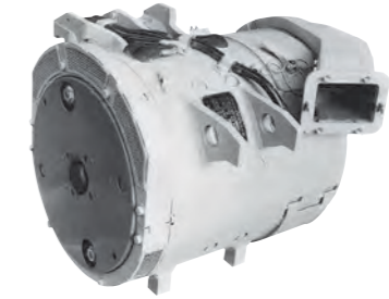
TDK806/1-A形主電動機 (1957年 小田急電鉄納入)
