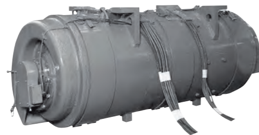
TDK3720-A形電動発電機 (1969年 京阪電気鉄道納入)
