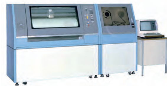
ドラム型プロッタ ドラステム9000 (1979年)
