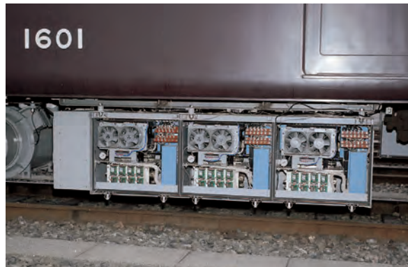
VVVFインバータ現車試験（1982年 阪急電鉄にて）
