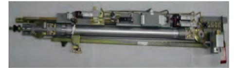
電磁弁一体形両開き扉用戸閉装置 (Y4形)
