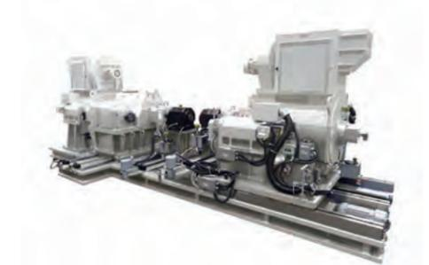
自動車用試験機(トルクコンバータ/クラッチバックデュアルテスタ 2017年)
