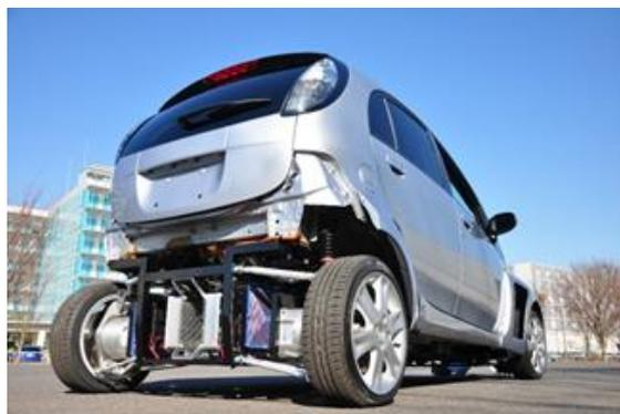
図2 ワイヤレスインホイールモータ搭載車
