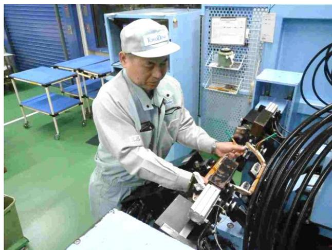
鉄道車両用誘導電動機 固定子コイル製作作業
