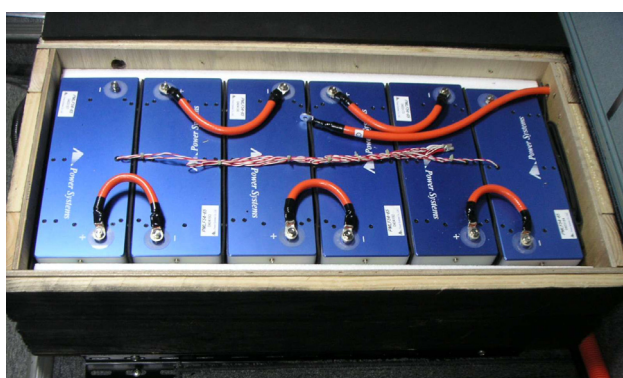
図10 キャパシタの収納状態 Fig. 10 Internal view of battery box
