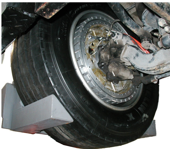
図5 フロントアクスル部の写真 Fig.5 Front axle with in-wheel motor
