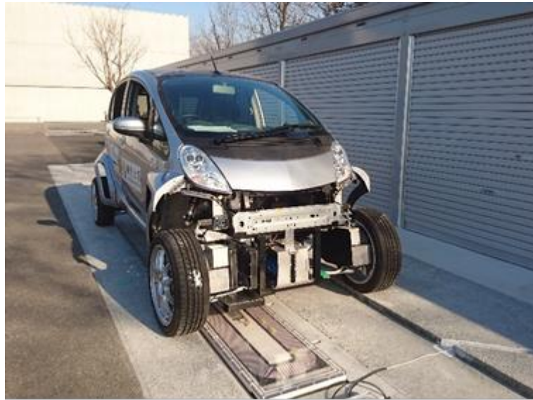
図 1 ワイヤレスインホイールモータ 2号機
