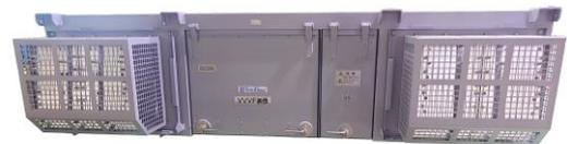
■ VVVFインバータ制御装置 外観
