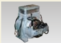
三相交流整流子電動機(シユラゲ形※のちのASモータ)
