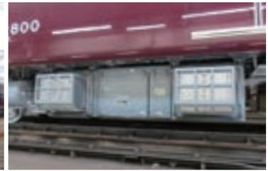
推進制御装置(VVVFインバータ) 外観
