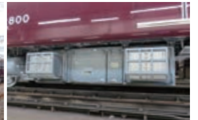
推進制御装置(VVVFインバータ) 外観 (写真提供: 阪急電鉄株式会社)
