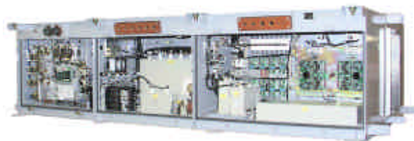
JR東日本E2系1000番代新幹線電車用補助電源装置
