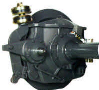
JR東日本E231系電車用駆動装置
