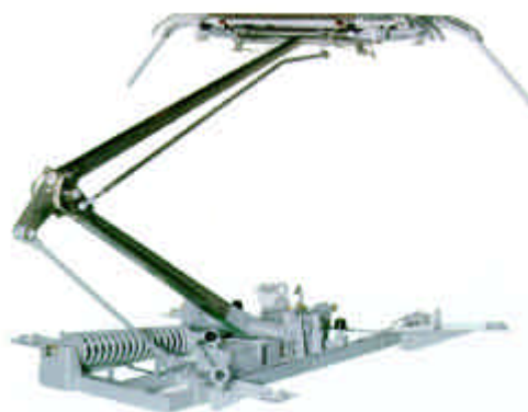
JR東日本201系電車用雪害対策パンタグラフ
