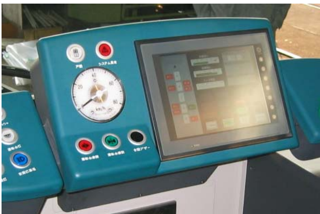
写真1 運転台表示器
