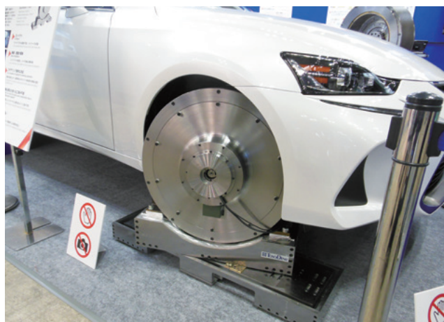
■ 実車両に取り付けた扁平型ダイナモ
