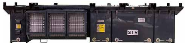
■ 補助電源装置
