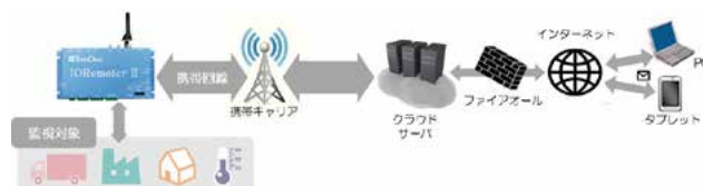
■ 図2 クラウド型遠隔監視システム
